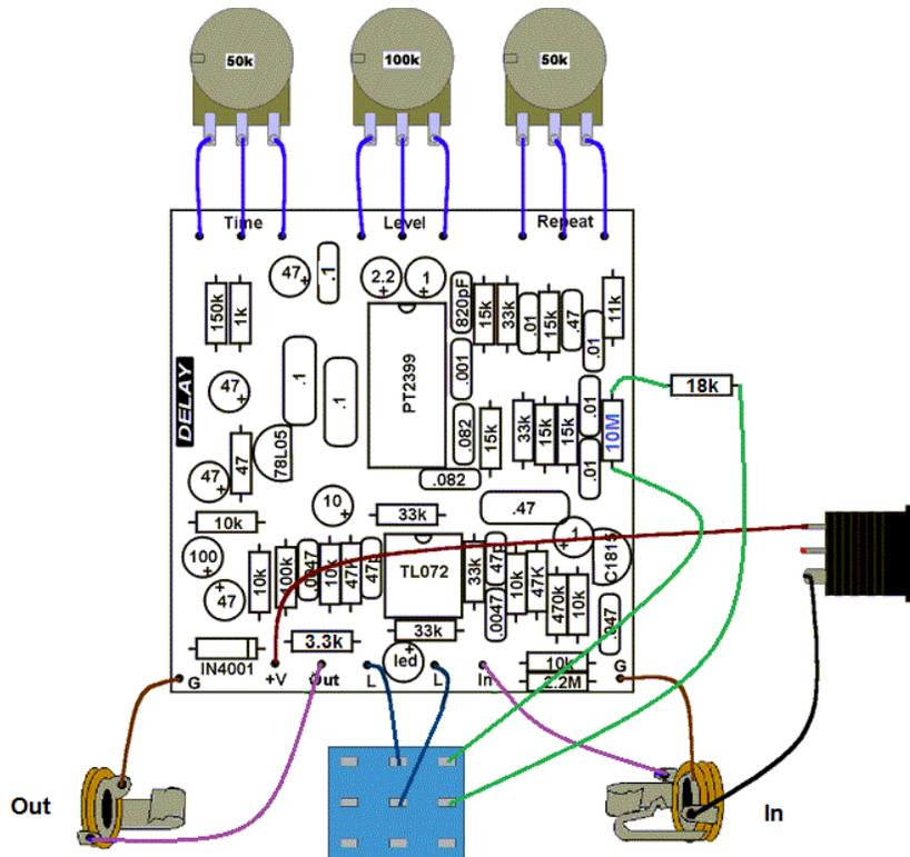
**True Bypass / Tails bypass** (seleccionable con un switch dpdt toggle) VERIFICADO
